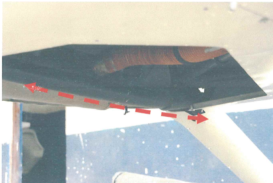
Daño severo en la estructura de soporte de los esquís o tren de aterrizaje.
