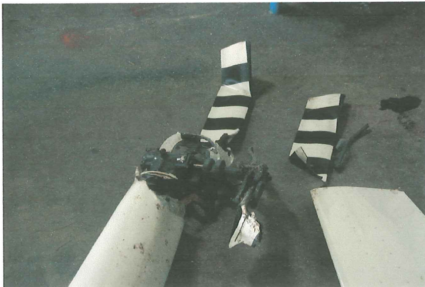
Sección del rotor de cola y sus accesorios, destruidos totalmente.
