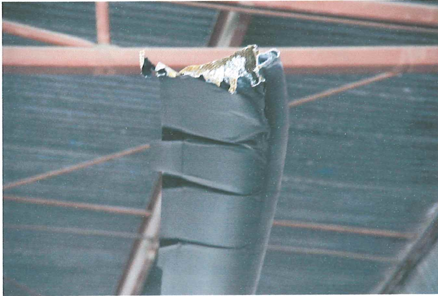
Daño severo en las dos palas del rotor principal.
